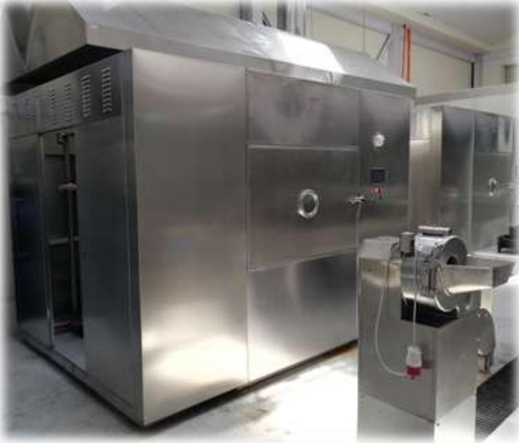
Deshidratador Micronondas - Vacío
